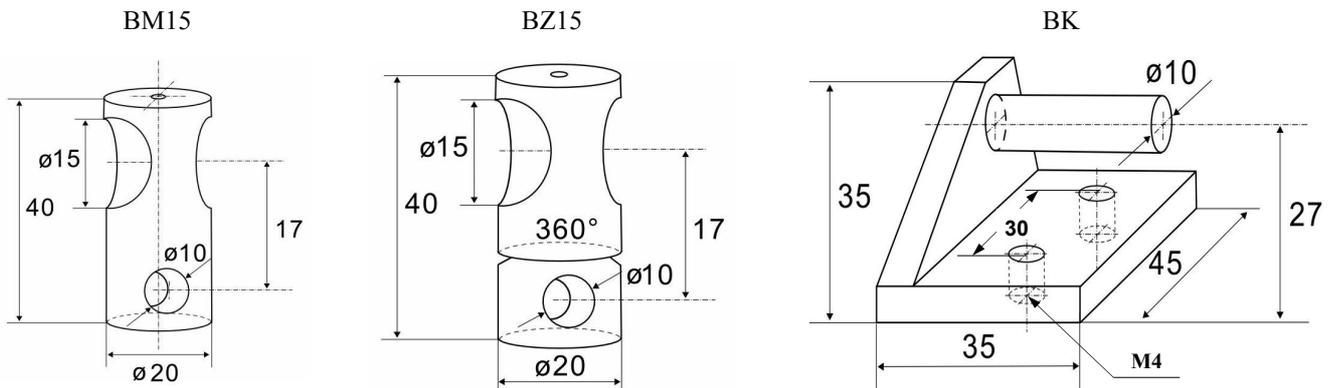
Die zwei und dreidimensionalen Halter BM & BZ15 sind für Ø 15 mm Lasermodule geeignet.
