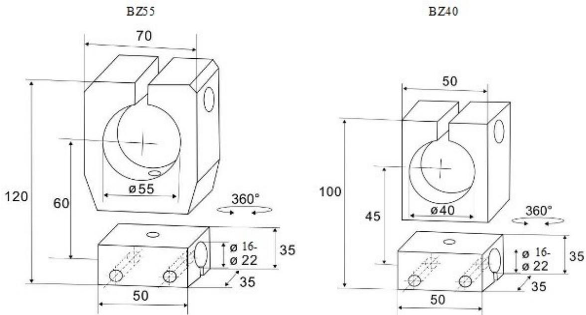
Der Laserhalter BZ55 dient zur Aufnahme von Ø 55 mm Geräten.
